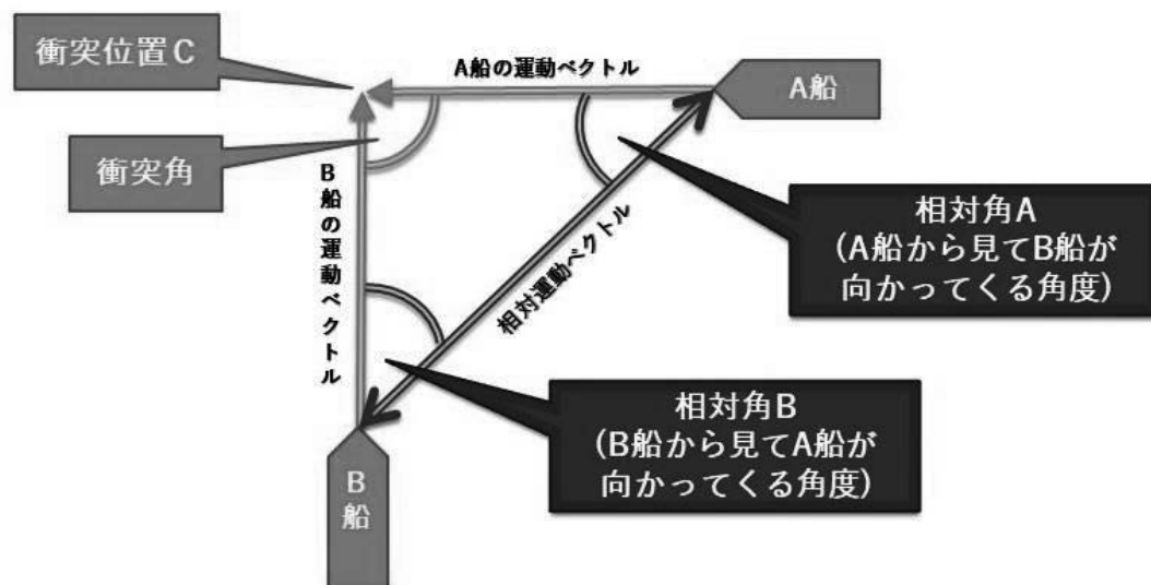
図8 両船の相対運動を考慮した衝突直前の状況 4)に基づき作成
