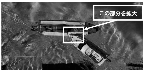
図10 衝突状況の一例（衝突角150°の場合）
