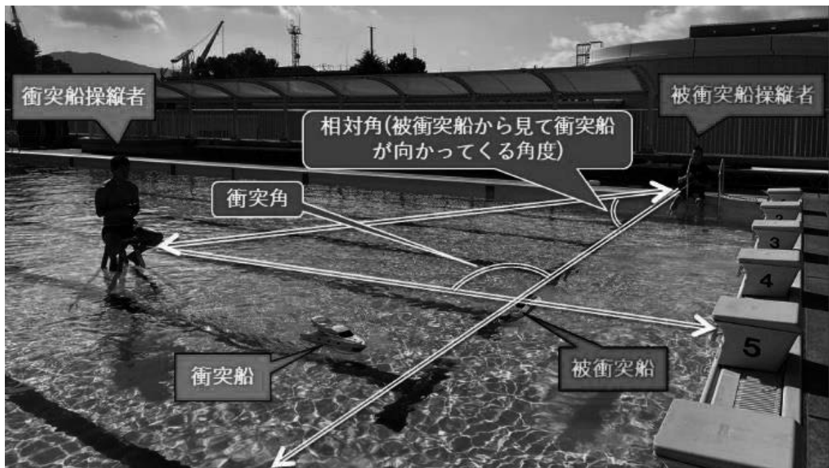
図9 訓練用プールでの衝突模型実験の実施状況
