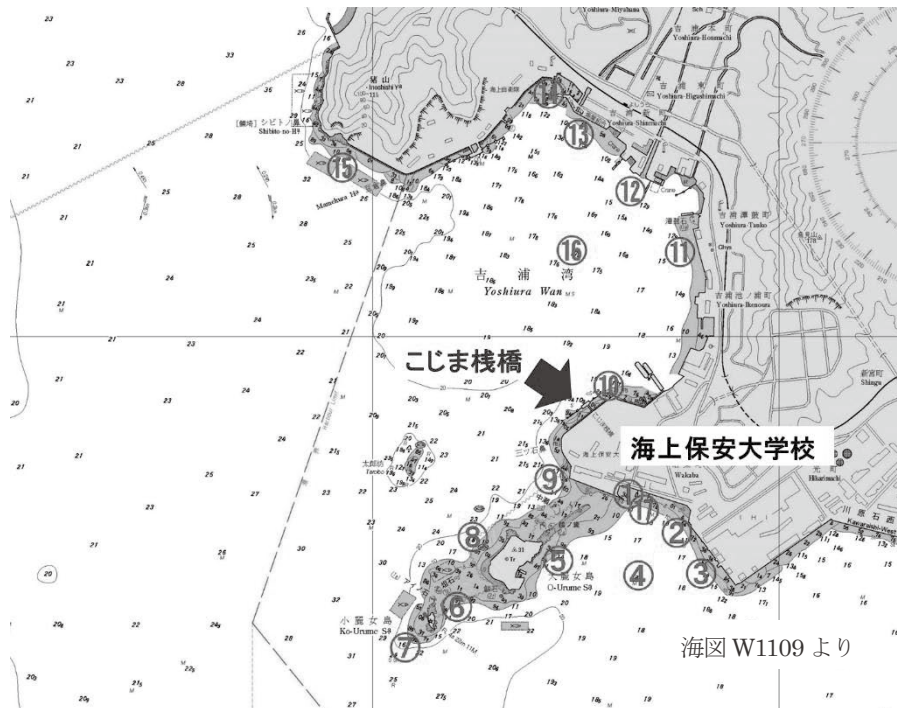
図3 海洋実験を行った海上保安大学校および吉浦湾周辺海域（海上保安庁海図 W1109 より抜粋、図中の番号はパルス性雑音の分布状況の調査を行った 17 の計測地点、並びに矢印は定点観測を行った大学校練習船こじま桟橋）
