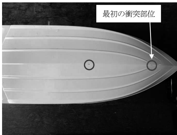
図 20 固定状態，衝突角 90^\circ ， F_n=0.55 の場合の傷
