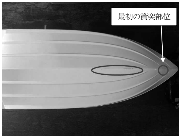
図9 漂泊状態，衝突角 90°， Fn=0.30 の場合の傷
