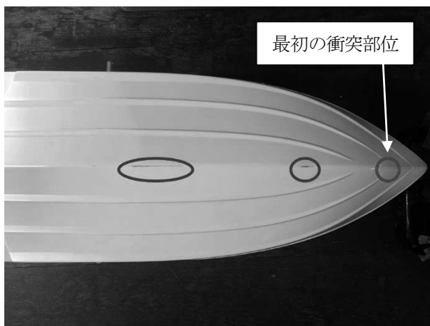
図10 漂泊状態，衝突角 90°， Fn=0.43 の場合の傷
