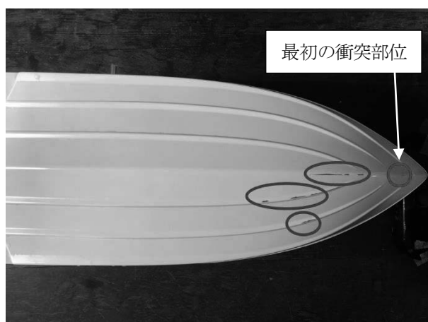
図 15 漂泊状態、衝突角 120^\circ 、 Fn=0.30 の場合の傷
