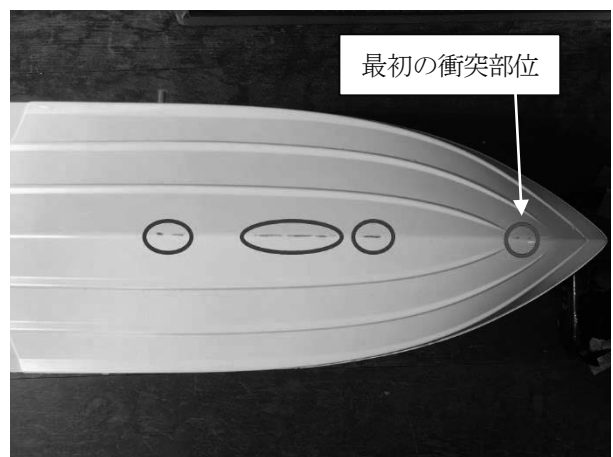
図14 漂泊状態，衝突角 60°， Fn=0.55 の場合の傷
