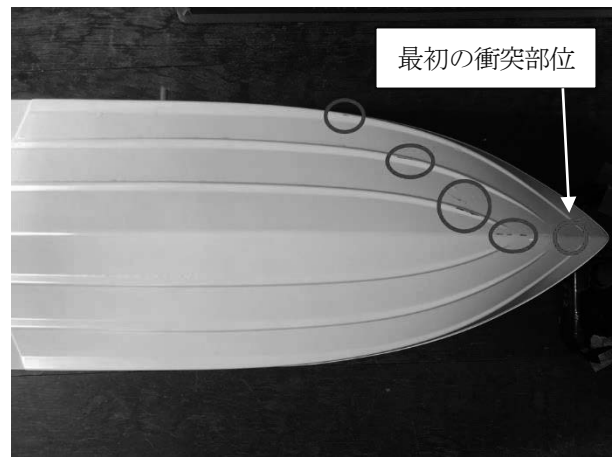
図12 漂泊状態，衝突角 60°， Fn=0.30 の場合の傷
