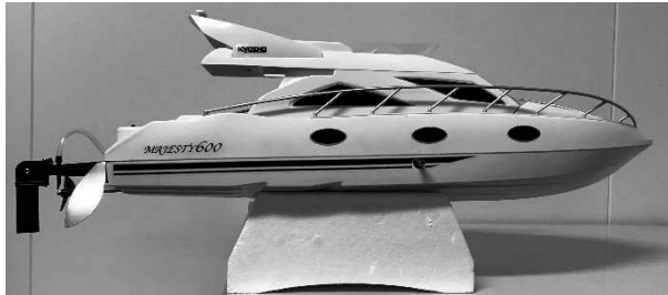
図2 衝突船(プレジャーボート型)の船体側面外観
