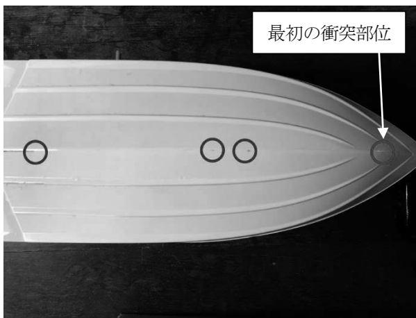
図 19 固定状態，衝突角 90^\circ ， F_n=0.43 の場合の傷
