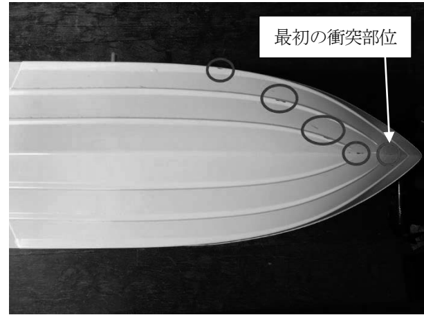
図 21 固定状態，衝突角 60^\circ ， F_n=0.30 の場合の傷
