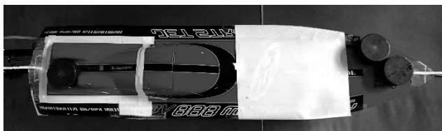
図4 被衝突船(レースボート型)のウェイト搭載状況 (0.5kgのウェイトを船首部に2つ、船尾部に1つ搭載、 船内船底部にも0.6kgのウェイトを1つ搭載:計2.1kg)
