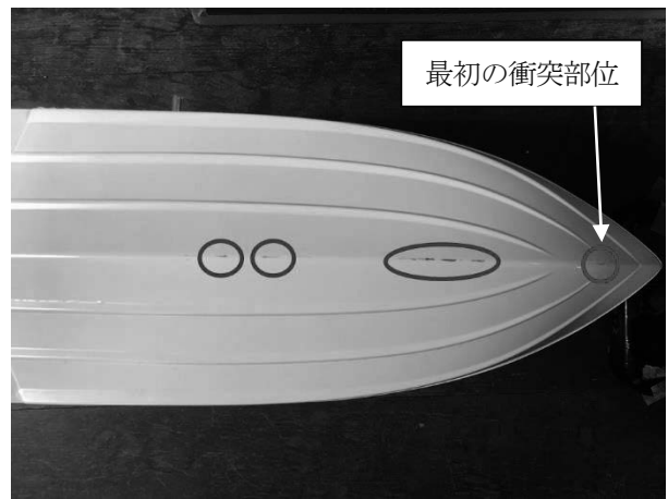
図13 漂泊状態，衝突角 60°， Fn=0.43 の場合の傷
