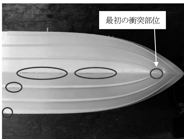
図 26 固定状態、衝突角 120^\circ 、 Fn=0.55 の場合の傷
