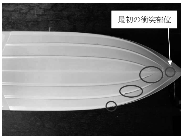
図 24 固定状態、衝突角 120^\circ 、 Fn=0.30 の場合の傷
