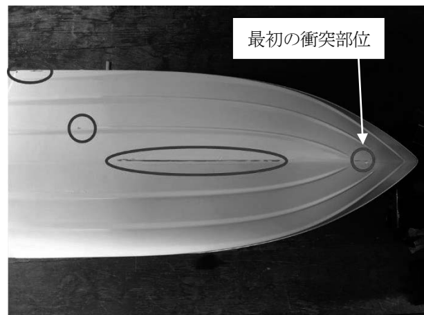
図 23 固定状態，衝突角 60^\circ ， F_n=0.55 の場合の傷
