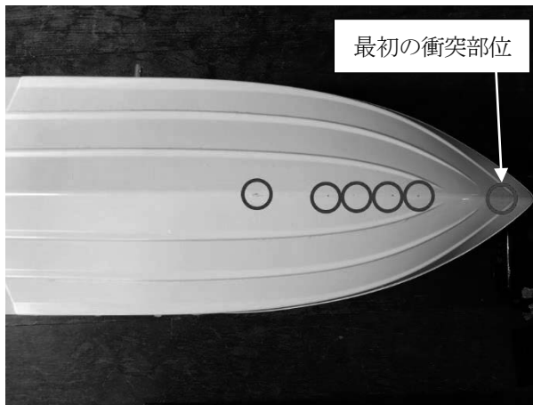
図 18 固定状態，衝突角 90^\circ ， F_n=0.30 の場合の傷
