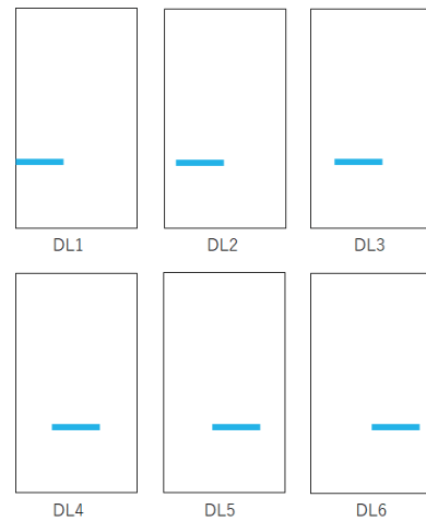
(a) 解析モデル(DL Type) と付加減衰位置 (付加減衰位置は y=0.194\text{m} で一定とし、左端の位置を0mから0.08mずつ右にずらしている。)
