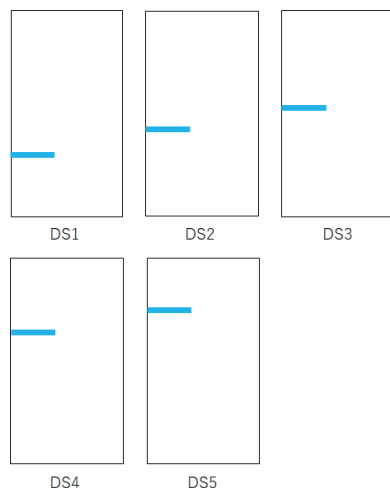
(c) 解析モデル(DS Type) と付加減衰位置 (付加減衰位置は x=0\text{m} で一定とし、左端の位置を y 方向に0.35mから0.078mずつ上にずらしている。)
