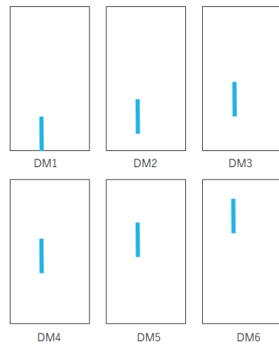
(b) 解析モデル(DM Type) と付加減衰位置 (付加減衰位置は x=0.194\text{m} で一定とし、下端の位置を0mから0.078mずつ右にずらしている。)
