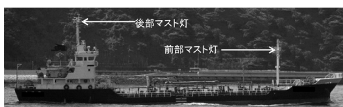
図3 一般的な貨物船のマスト灯の配置
