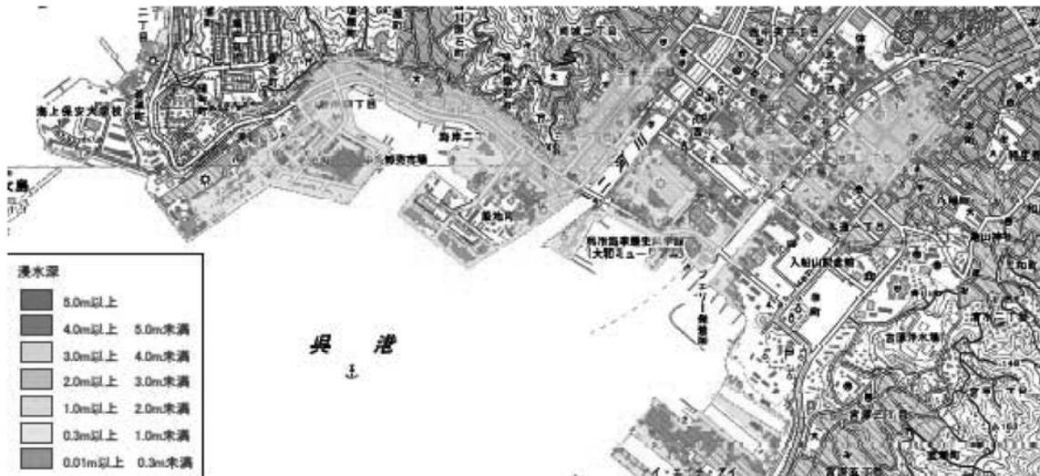
図2 呉市の津波浸水予想図(抜粋)<sup>3)</sup>
